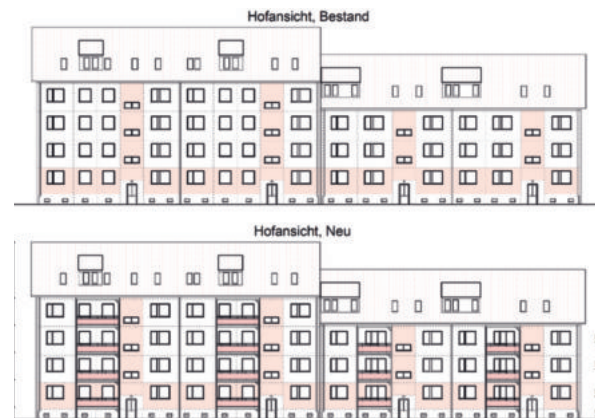
14 neue Balkone werden in diesem Jahr an der Hinterbreite 12-15 in Aschersleben angebaut.
