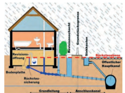
Rückstausicherung und Rückstauenebene
